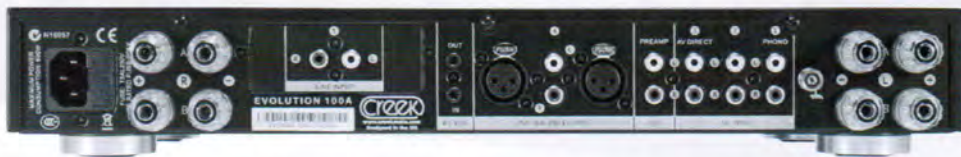
↑本機は、プリアンプ部をバイパスするパワーアンプダイレクト入力に対応している。また、追加モジュール用の空きスロットが設けられ、機能の拡張も可能。96kHz/24ビットまでの信号に対応するUSB入力を備えたRUBYDAC(¥97,000+税)、AM/FMチューナーのAMBIT TUNER(¥29,000+税)が別売にて用意され、フォノイコライザー機能の追加は基板にフォノカードを差し込む方式でMM対応のSequel MM(40dB: ¥28,000+税/48dB: ¥35,000+税)とMC対応のSequel MC(54dB: ¥35,000+税)を用意する
