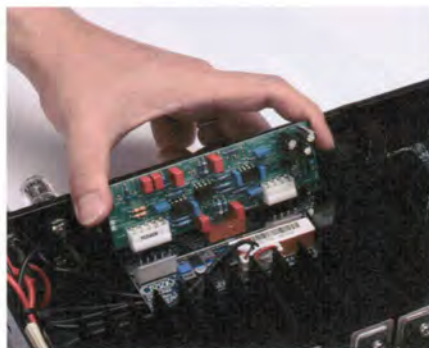
フォノカードは内部基板上に直接取り付け。カバーを開けて、差込むだけで作業は完了する
