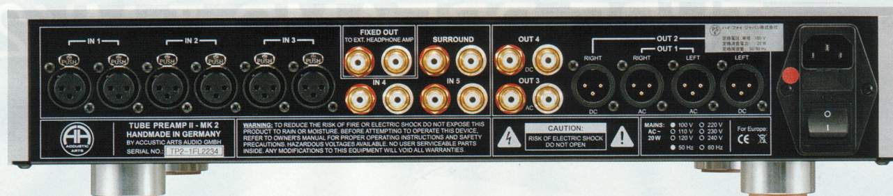
TUBE PREAMP II - MK2 のリアパネル。入力端子はRCA×2とXLR×3の5系統を持つ。プリアウトはRCAとXLR各2系統。メインスイッチは電源ケーブルのインレットの下に置かれている
